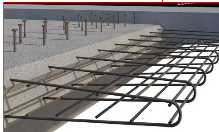
Dodatkowo wklejane łączniki zbrojeniowe
