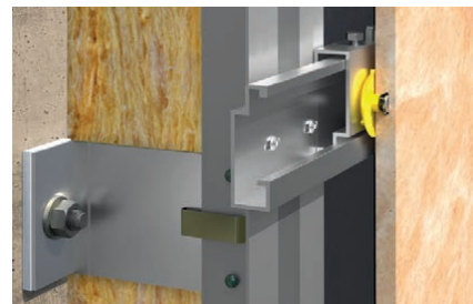
Szczegół fasady z kotwą ceramiczną
