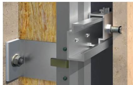
Szczegół fasady z kotwami montowanymi z odstępem
