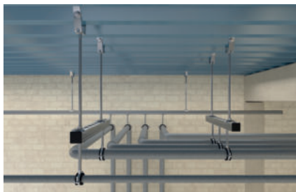
Rurociągi podwieszane do dachu z blachy trapezowej
